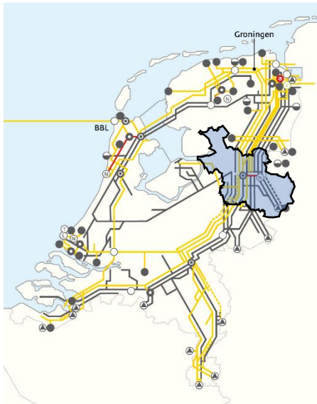
Figuur 14: Schematische overzichtskarta gastranspport net. Grijs zijn de G-gasleidingen en geel zijn de H-gasleidingen. 7
